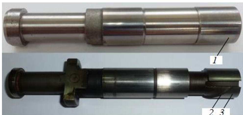
1 - рабочая часть плунжера ЭТНВД; 2 – отсечная кромка; 3 – рабочая часть плунжера ТНВД с механическим управлением топливоподачей
